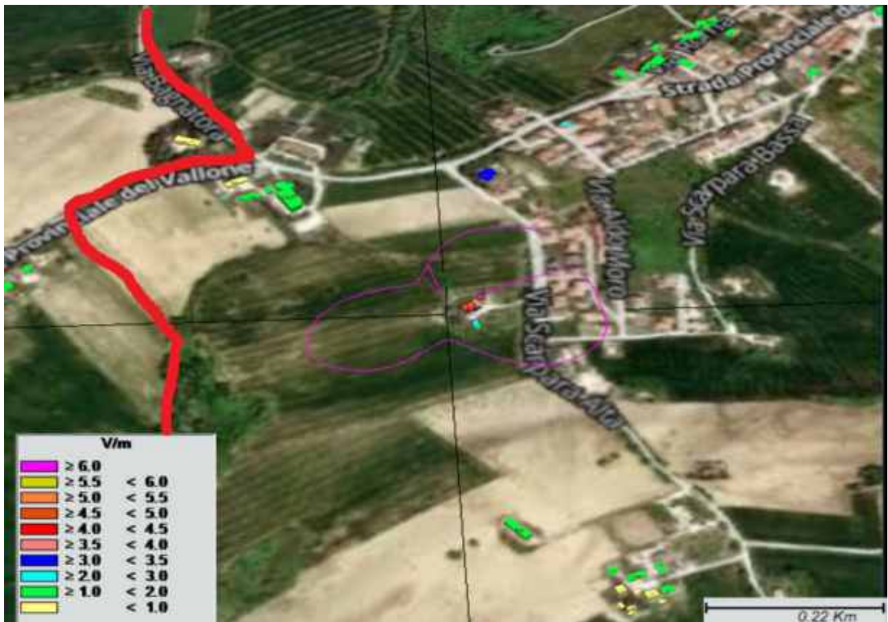
Figura 43 - Intensità del campo elettrico sulle coperture degli edifici relativamente alla postazione A6 ubicata in Via Scarpata Alta nel Comune di Santa Maria Nuova
