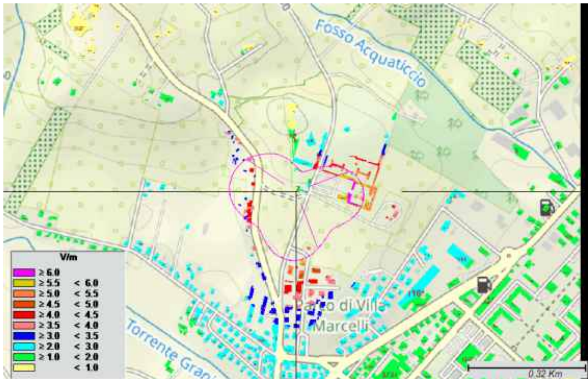
Figura 31 - Intensità del campo elettrico sulle coperture degli edifici relativamente alla postazione E11 ubicata presso Cimitero Comunale
