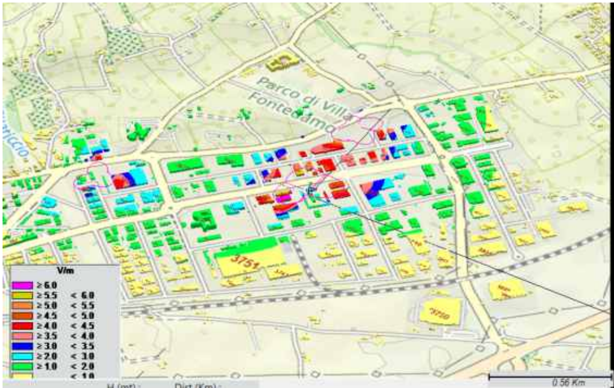
Figura 50 - Intensità del campo elettrico dall'alto e della distribuzione dello stesso relativamente all'area della Zona Industriale - dettaglio
