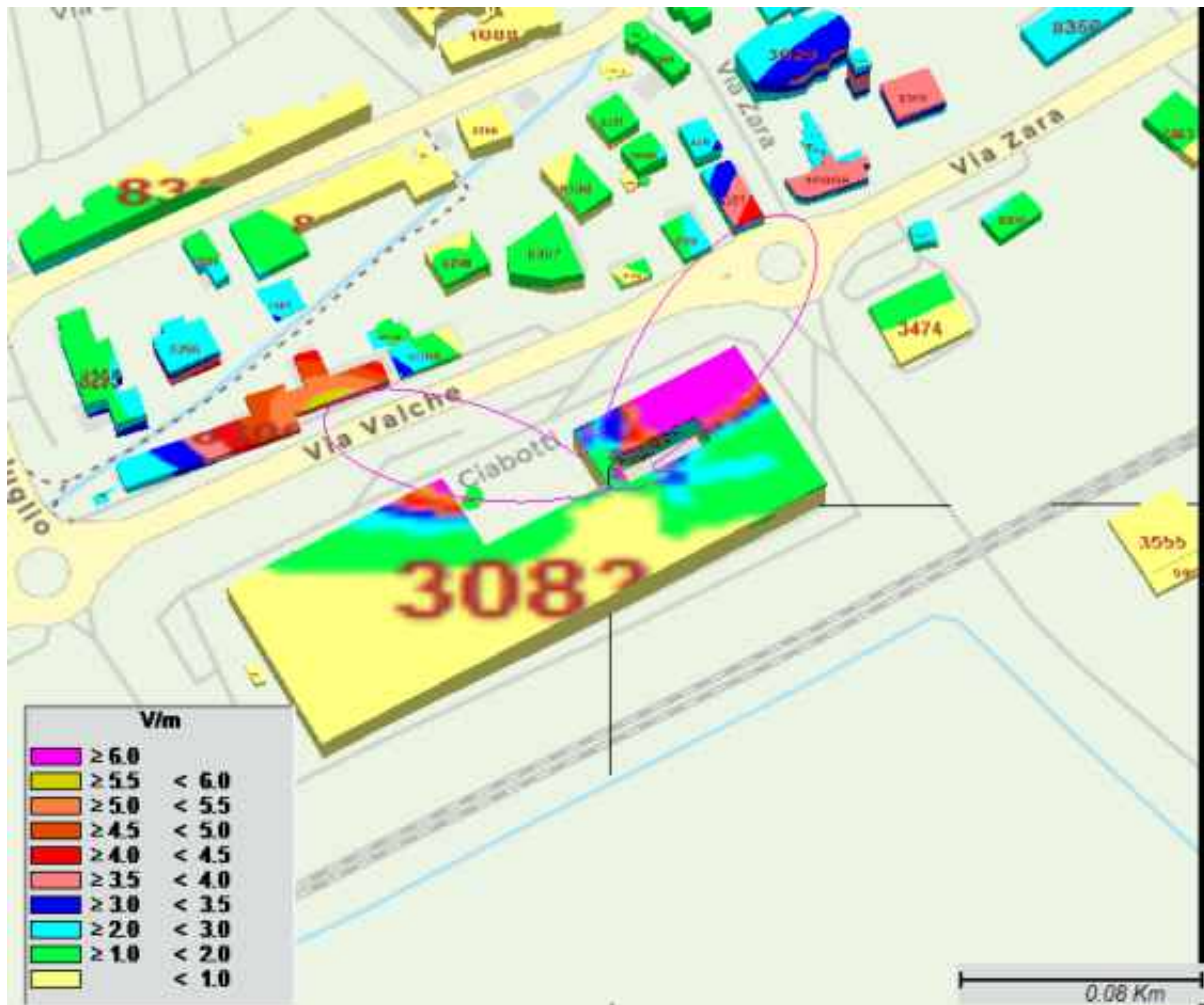
Figura 41 - Intensità del campo elettrico sulle coperture degli edifici relativamente alla postazione A2 ubicata presso il Centro Commerciale in Piazzale Anna Ciabotti – dettaglio
