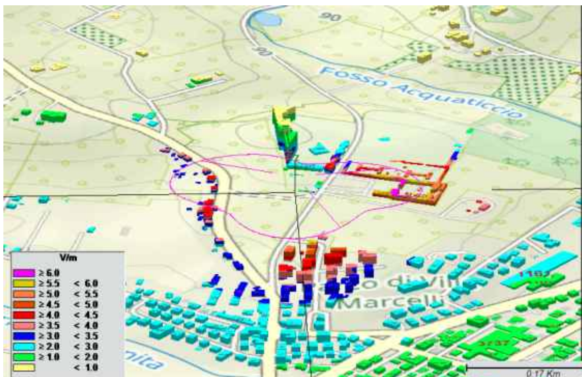
Figura 32- Intensità del campo elettrico sulle coperture degli edifici relativamente alla postazione E11 ubicata presso Cimitero Comunale - dettaglio
