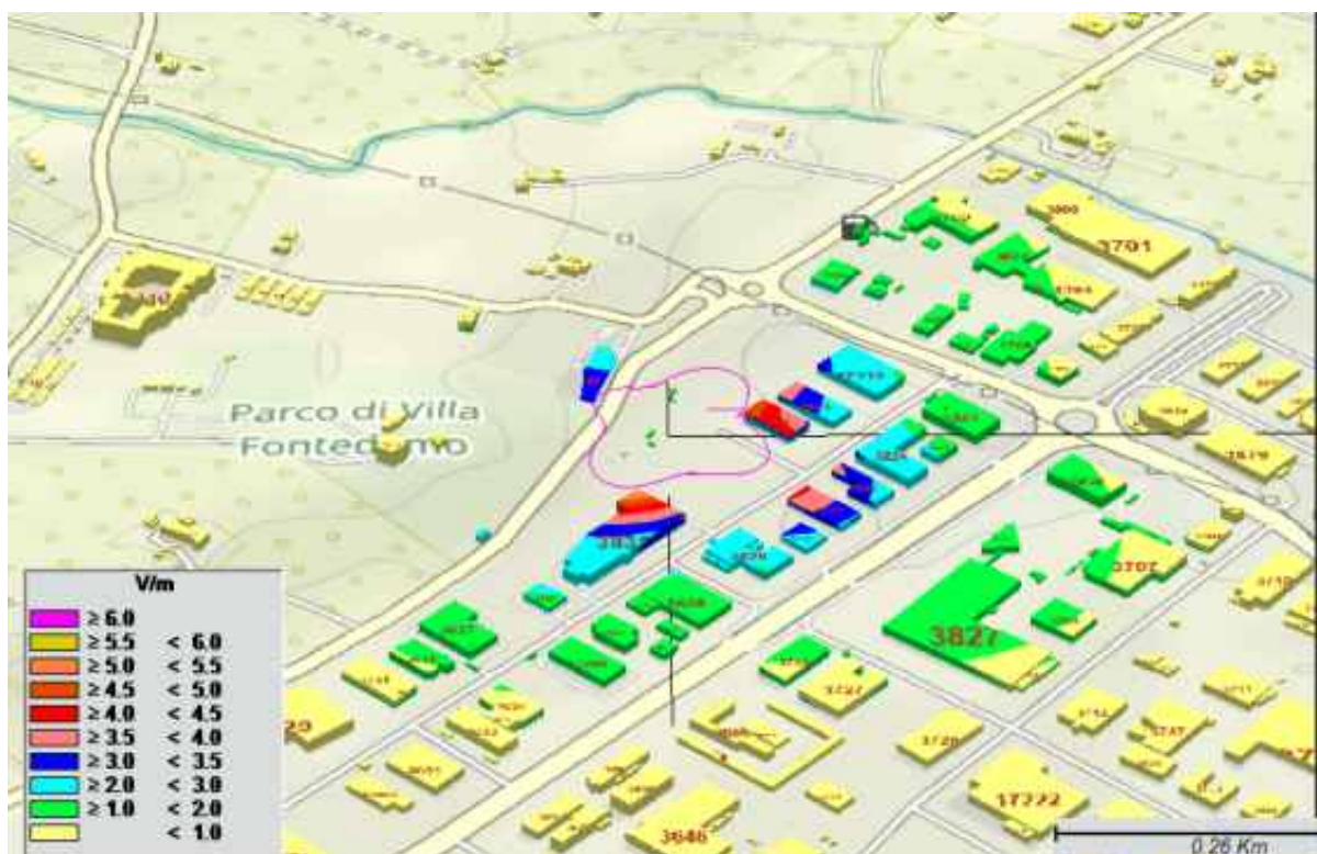
Figura 29 - Intensità del campo elettrico sulle coperture degli edifici relativamente alla postazione E10 ubicata in Piazzale dei Divertimenti - dettaglio
