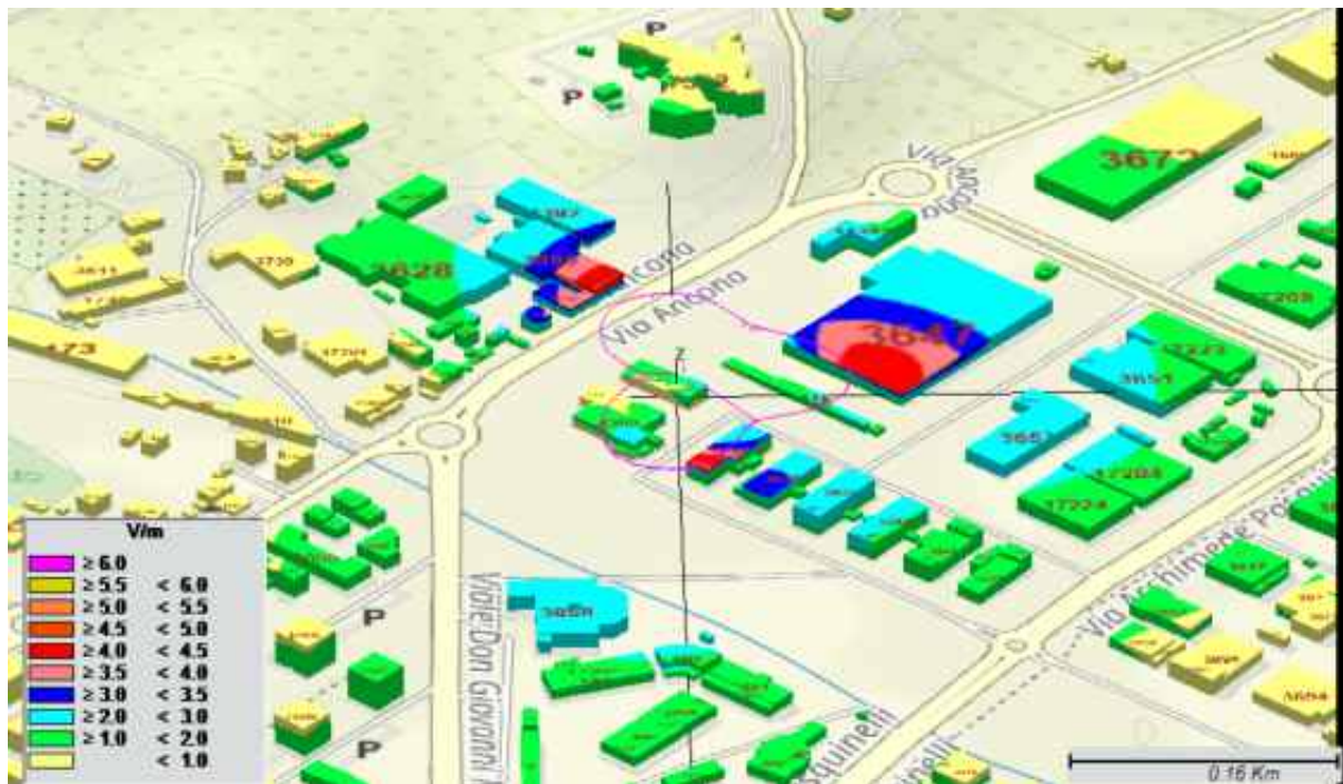
Figura 26 - Intensità del campo elettrico sulle coperture degli edifici relativamente alla postazione E9 ubicata in Via Santi 4 - dettaglio
