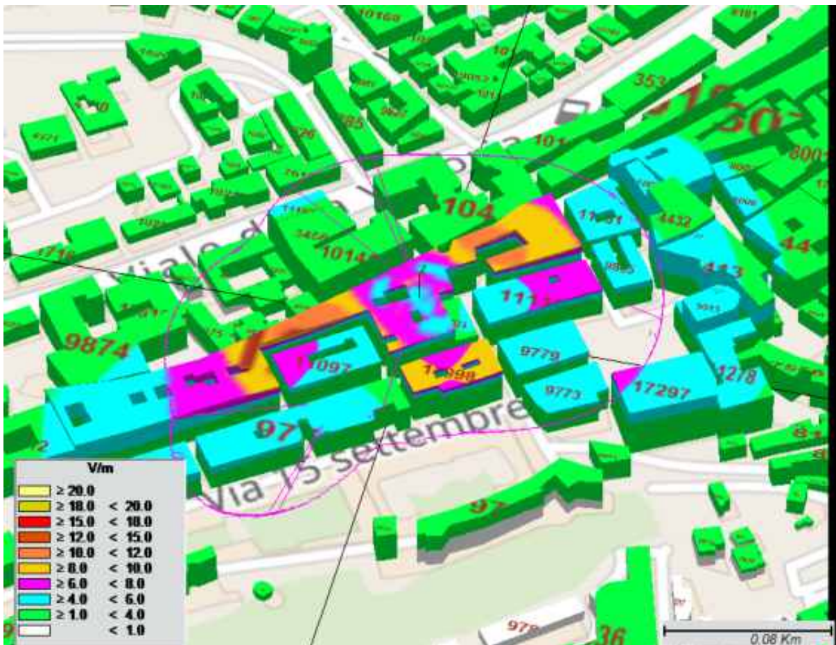
Figura 46 - Intensità del campo elettrico dall'alto e della distribuzione dello stesso relativamente alla zona del Centro Storico - dettaglio
